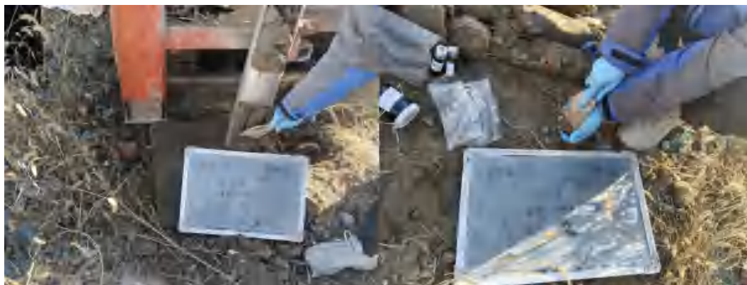
图 4-6 土壤样品现场采集
